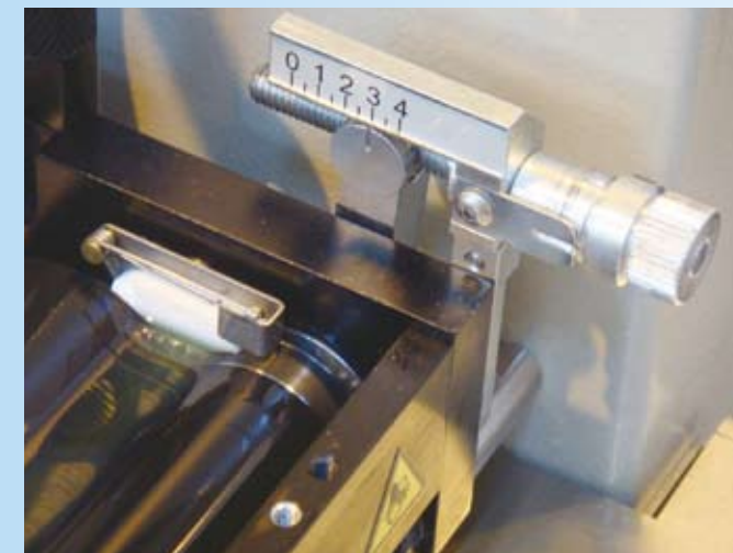
Kompac 独自のメタリングコントロールシステム
